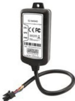
Der **kompakte GPS Tracker** mit integrierten GSM-Antennen, im wasserdichten IP67-Gehäuse und **Bordnetzanschluss**, wird an Plus (KL30), Minus (KL31) und an die Zündung (KL15) im Zweirad, Trike oder Quad angeschlossen. Die GPS Ortung erfolgt in Echtzeit bei **Zündung EIN** und bei **Bewegung**.
